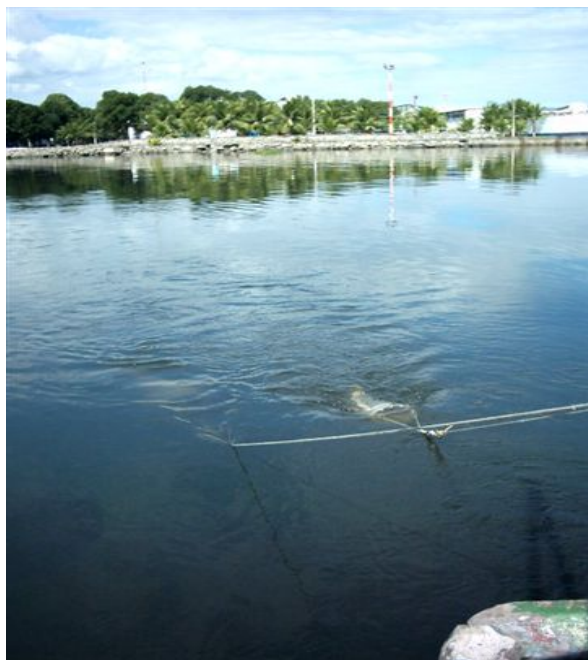
Figuras III-2 e III-3 - Amostragem de plâncton (rede) na área da bacia de atracação de embarcações da Intercan, a cerca de trezentos metros de distância da área de interesse do projeto
