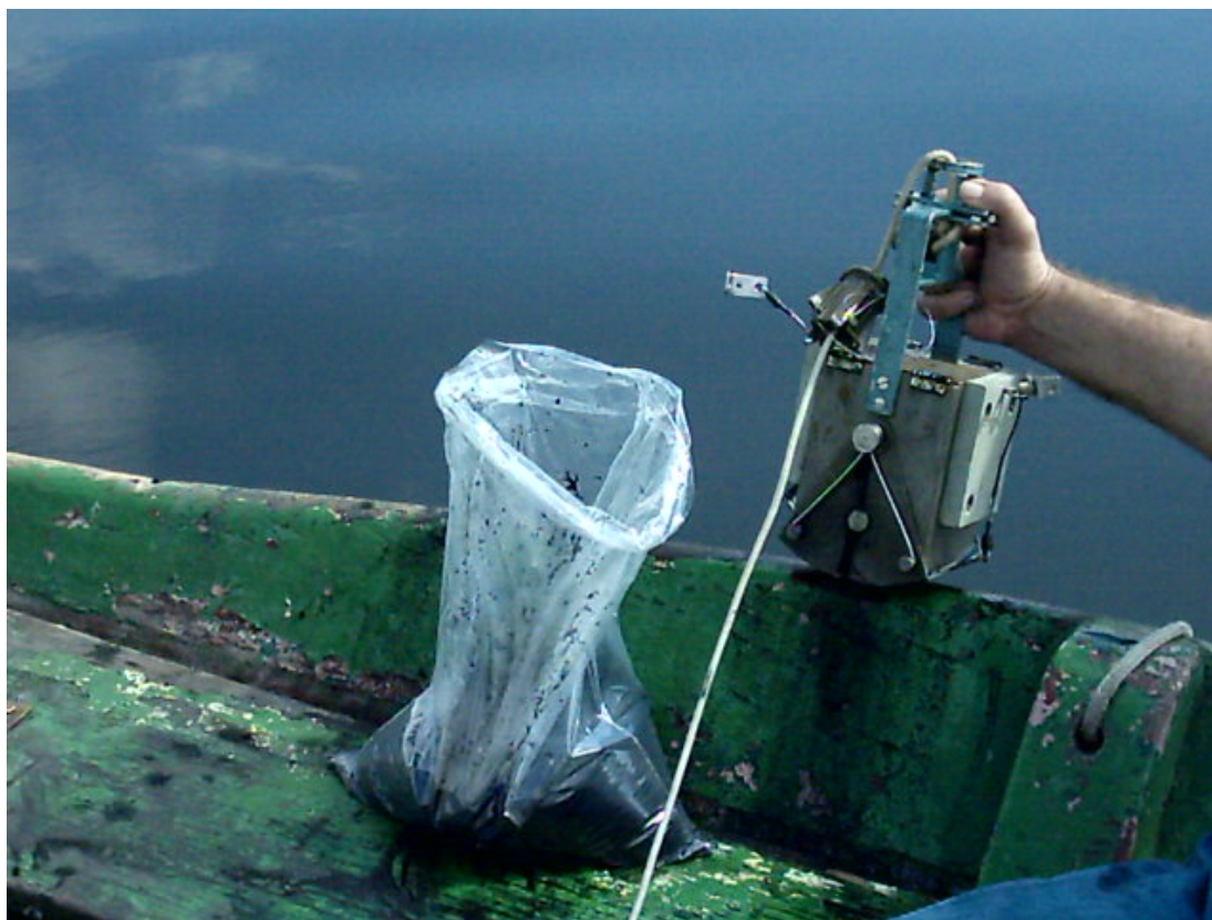
Figura III-5 - Coleta de amostra de bentos com busca-fundo do tipo Eckman
