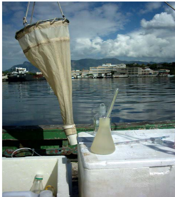
Figuras III-2 e III-3 - Amostragem de plâncton (rede) na área da bacia de atracação de embarcações da Intercan, a cerca de trezentos metros de distância da área de interesse do projeto
